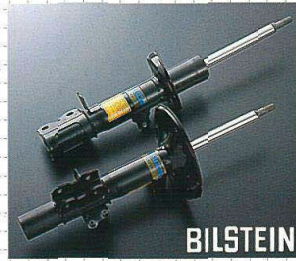
■ビルシュタイン社製ショックアブソーバー (上) リヤ用 (下) フロント用
